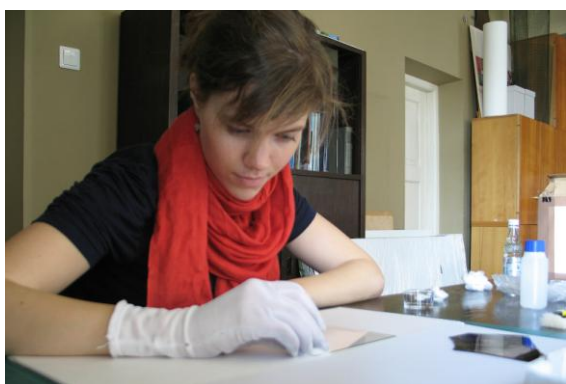
39. Tugiklaaside ettevalmistamine: puhastamine dest. vee ja etanooliga, 15. IV 2011.
