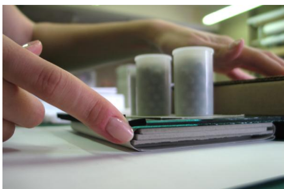
43. Kalingurteibi kinnitamine klaasi servadesse. Selleks, et kihid jääksid tihedalt üksteise vastu, kasutati lokaalseid raskusi, 27. IV 2011.
